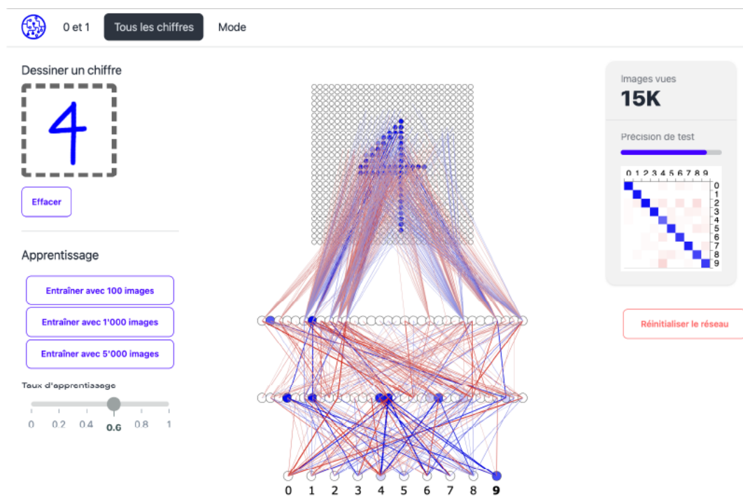
Fig. 2. Volet « Tous les chiffres » du simulateur. Les élèves manipulent le taux d'apprentissage pour entraîner un réseau de neurones artificiels à reconnaître les chiffres 0 à 9 à partir d'un jeu de données. L'interface permet d'observer en temps réel l'évolution des poids au cours de l'apprentissage et met en évidence la nécessité de disposer de jeux de données volumineux. La visualisation montre également que, même lorsque le réseau est globalement performant, certains chiffres demeurent plus difficiles à reconnaître que d'autres.
